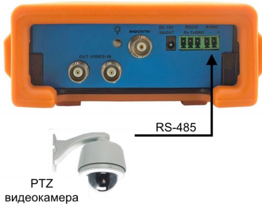
Рис.7 Подключение управляемой PTZ видеокамеры к тестеру
