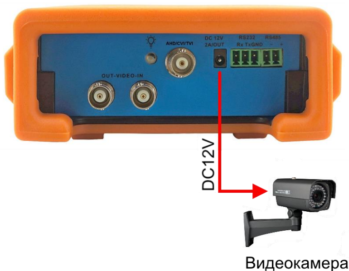
Рис. 4 Подключение питания DC 12V к видеокамере от тестера
