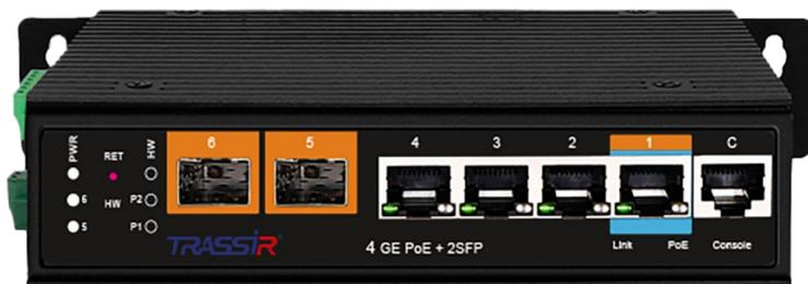
**TR-NS27062S-250-4POE** – управляемый промышленный коммутатор с 4 PoE-портами 10/100/1000 Мбит/сек с возможностью подачи питания к подключенным устройствам по витой паре до 250 м и креплением под коммутационные шкафы.
