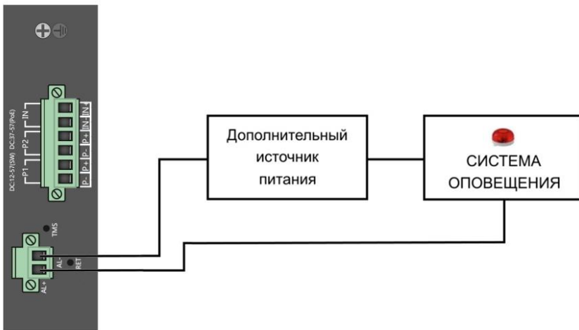
Рис.9 Схема подключения системы оповещения к коммутаторам SW-80804/ILS(port 90W 300W) и SW-80804/ILS(port 90W 720W)
