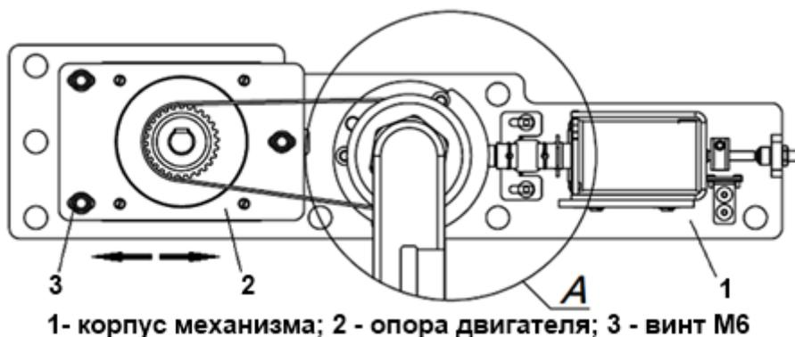
1- корпус механизма; 2 - опора двигателя; 3 - винт М6
