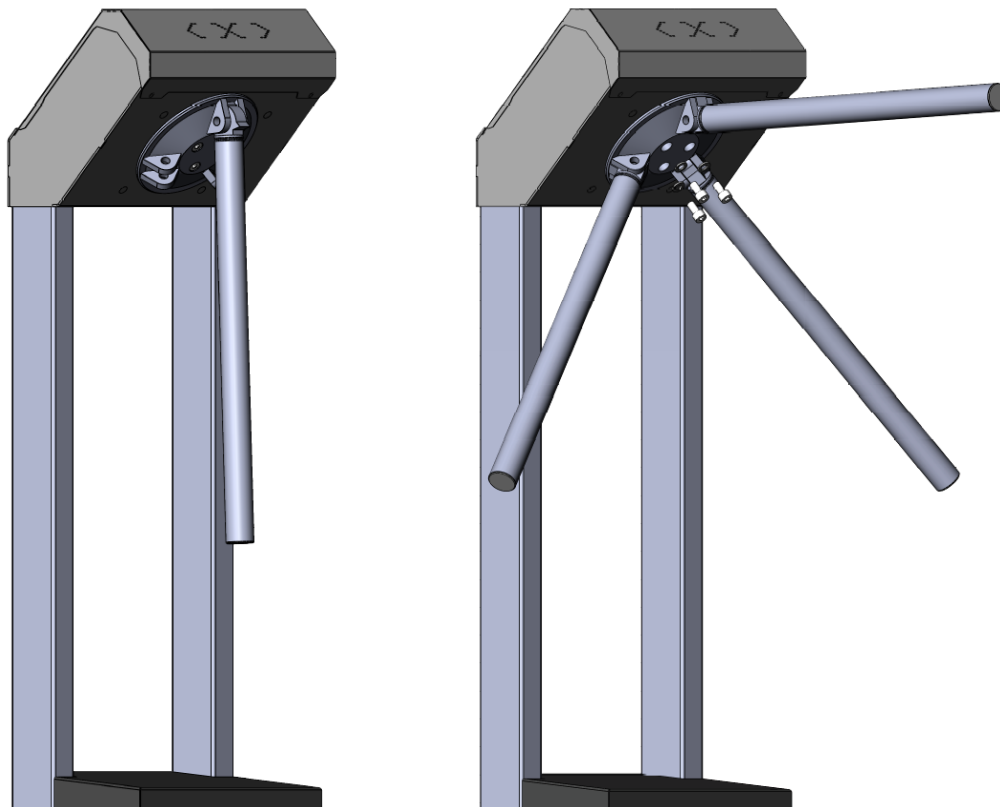
Рисунок 1.7.3 – Использование преграждающих планок «Антипаника» турникета «Model A»
