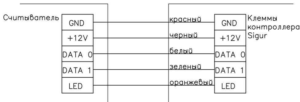
Рисунок 3.2.3 – Схема расключения считывателей турникетов на контроллер Sigur E500, Sigur E500U
