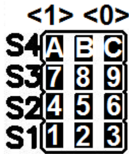
Рисунок 2.1.4 – Перемычки режимов работы платы управления
