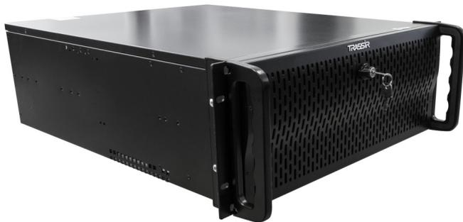
**TRASSIR NeuroStation Pro** – сетевой видеорегистратор для IP-видеокамер под управлением TRASSIR OS (Linux) с поддержкой видеоналитики на основе нейронных сетей: детекция проникновения людей в зону, подсчет количества людей в зоне (например, в очереди), а также поиск в архиве по людям. Поддержка Offload-аналитики (прием и обработка изображений передаваемых с других серверов TRASSIR).
