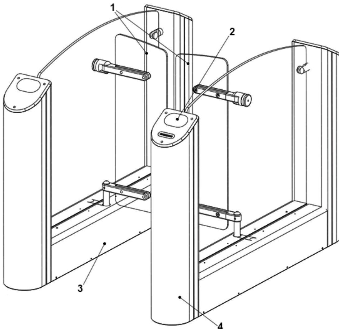
1- створки; 2 - панель индикации; 3 - крышка основания; 4 - картоприемник
