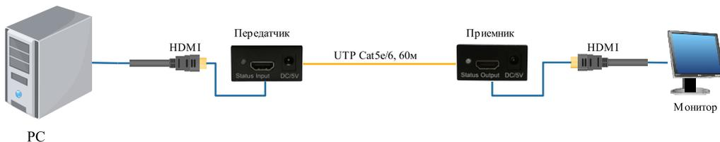
Рис.4 Типовая схема подключения комплекта
