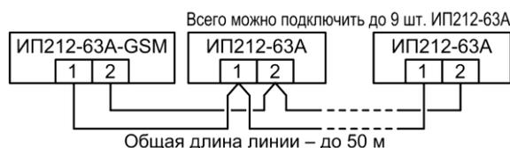
Рис.5 Схема соединения извещателей в группу с ИП212-63А-GSM
