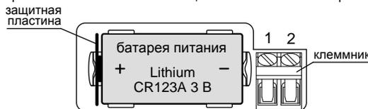
Рис.2 Батарейный отсек
