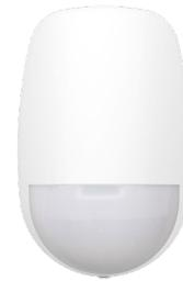
Извещатель DS-PDP15P-EG2-WE(B) является беспроводным PIR-датчиком с двусторонней беспроводной связью, функцией обнаружения движения, защитой от несанкционированного доступа, индикатором низкого заряда батареи и функцией мониторинга. Время работы от встроенной батареи достигает 5 лет. Извещатель выполняет мониторинг области в радиусе 15 м с фильтрацией ложных срабатываний на животных и детекцией человека.
