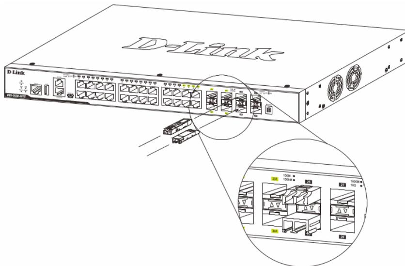
Трансивер DIS-S310R / DIS-S310T поддерживает возможность горячего подключения. Подключение трансивера к включенному устройству не приведет к возникновению каких-либо проблем. Это позволяет подключать или отключать трансивер без прерывания работы остальной сети.
