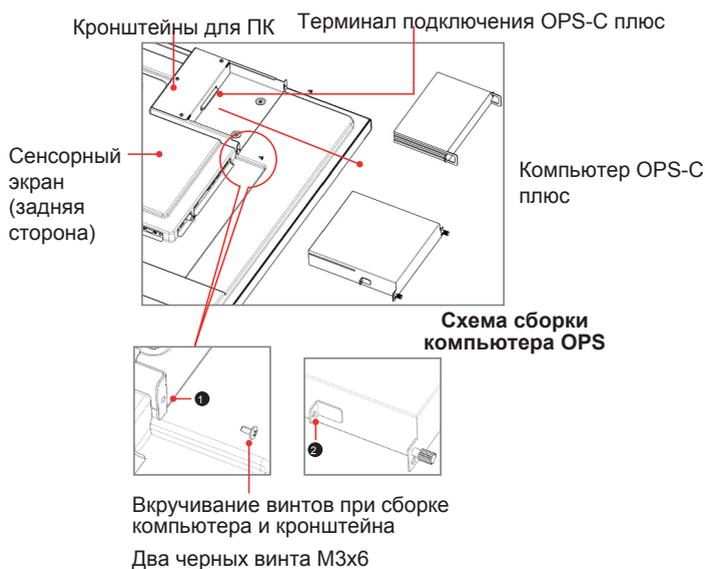
① расположен на кронштейне компьютера, и прикручивается винтами, которые совмещаются с ②.
