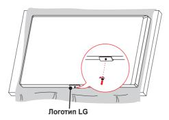
2 После удаления винта снимите логотип LG. Для установки логотипа LG повторите эти действия в обратном порядке.
