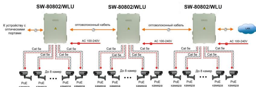
Рис.7 Каскадная схема подключения уличного коммутатора SW-80802/WLU
