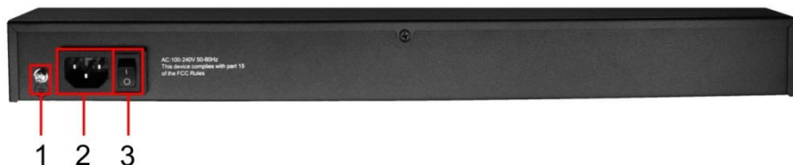
Рис.9 Коммутатор SW-72402/L2, разъемы и кнопки задней панели
