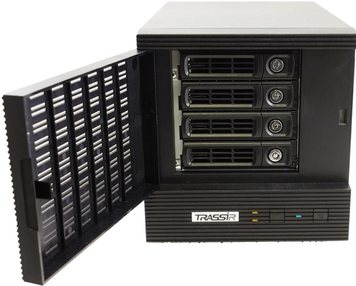
**TRASSIR NeuroStation 8400/32-S** - сетевой видеорегистратор для IP-видеокамер под управлением TRASSIR OS (Linux) с поддержкой видеоаналитики на основе нейронных сетей. Запись, воспроизведение, отображение до 32 IP-камер. Установка до 4-х HDD 3.5".
