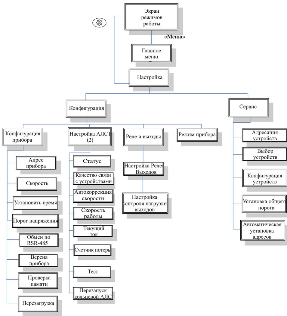
Рисунок А.3 – Структура экранов меню для уровня доступа «Инсталлятор» (окна, доступные первому и второму уровням доступа, не показаны)
