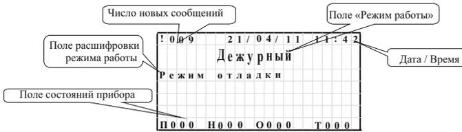
Поле состояний прибора – в данном поле отображается количество зафиксированных случаев пожара (П), неисправностей (Н), отключений (О) и тревог (Т). В случае ненулевого значения счетчика, он начинает моргать.
