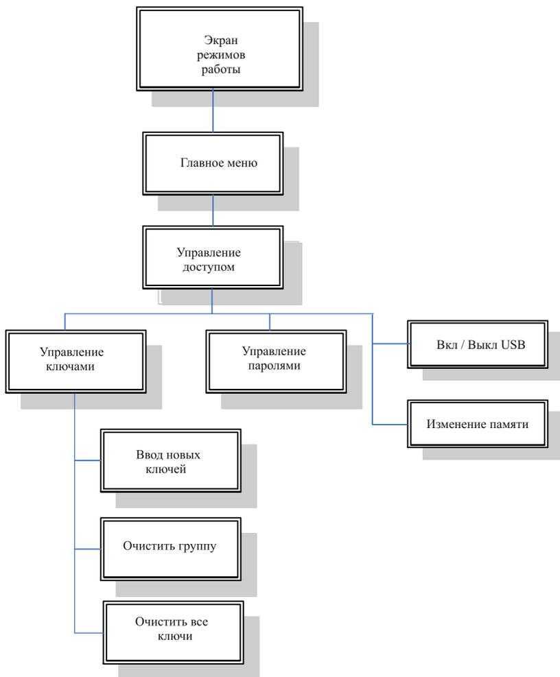
Рисунок А.4 – Структура экранов меню для уровня доступа «Администратор» (окна, доступные первому, второму и третьему уровням доступа, не показаны)
