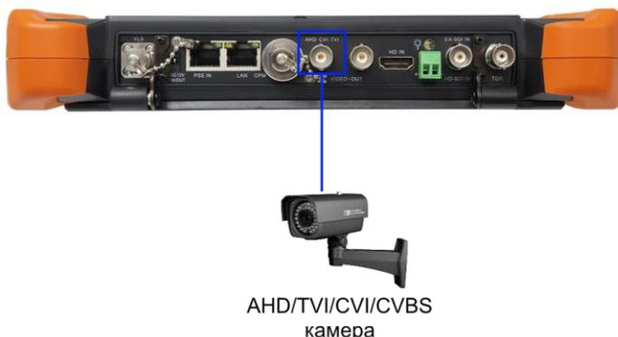
Рис. 13 Подключение AHD/TVI/CVI/CVBS видеокамеры к тестеру
