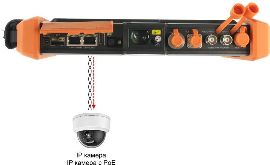
Рис. 7 Подключение IP-видеокамеры к тестеру
