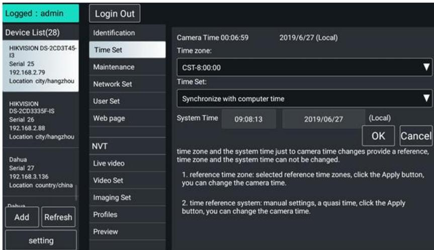
Рис. 45 Установка времени для IP видеокамеры
