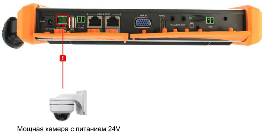
Рис. 10 Подключение питания к мощной IP-видеокамере без PoE
