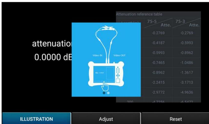
Рис. 131 Подключение кабеля для определения степени затухания
