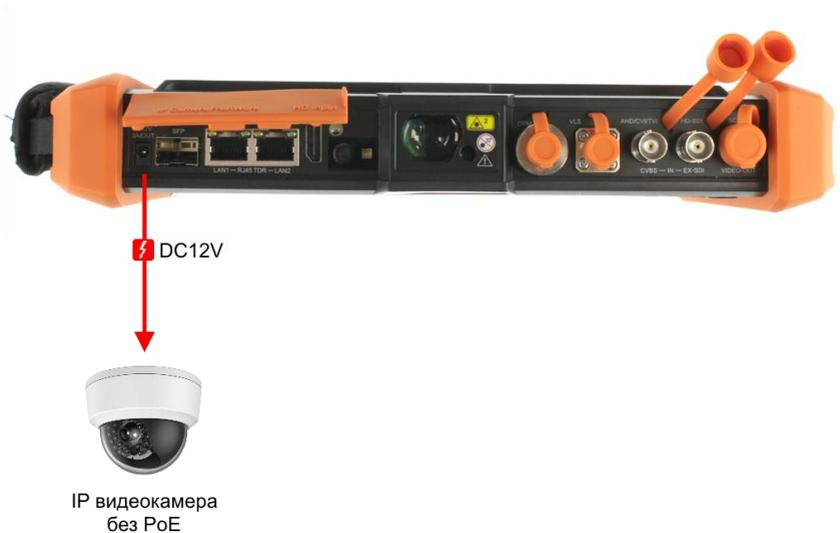
Рис. 9 Подключение питания к IP-видеокамере без PoE
