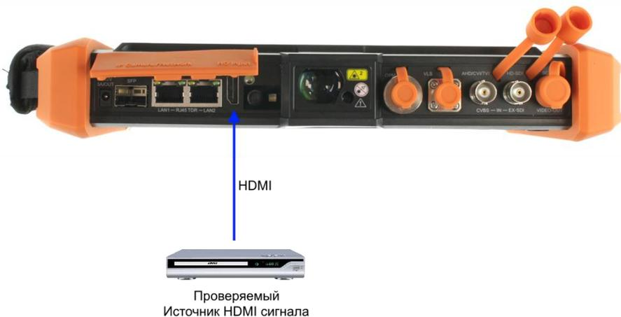
Рис. 17 Подключение HDMI устройств к тестеру.
