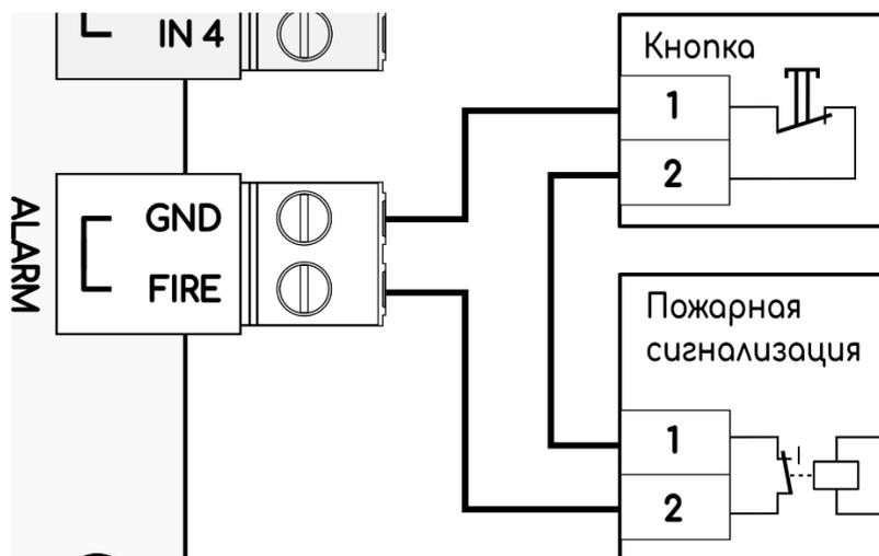
Рисунок 18. Подключение кнопки аварийной разблокировки и системы пожарной сигнализации
