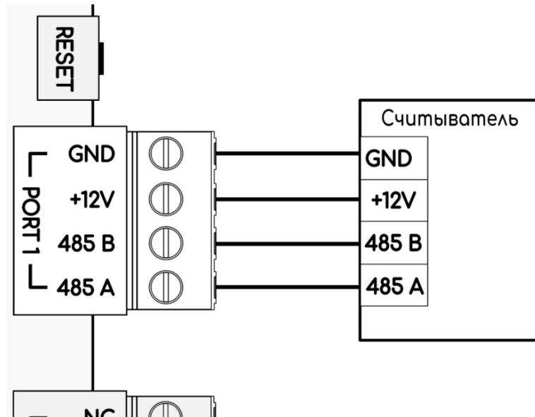
Рисунок 4. Подключение счетчика с питанием от контроллера
