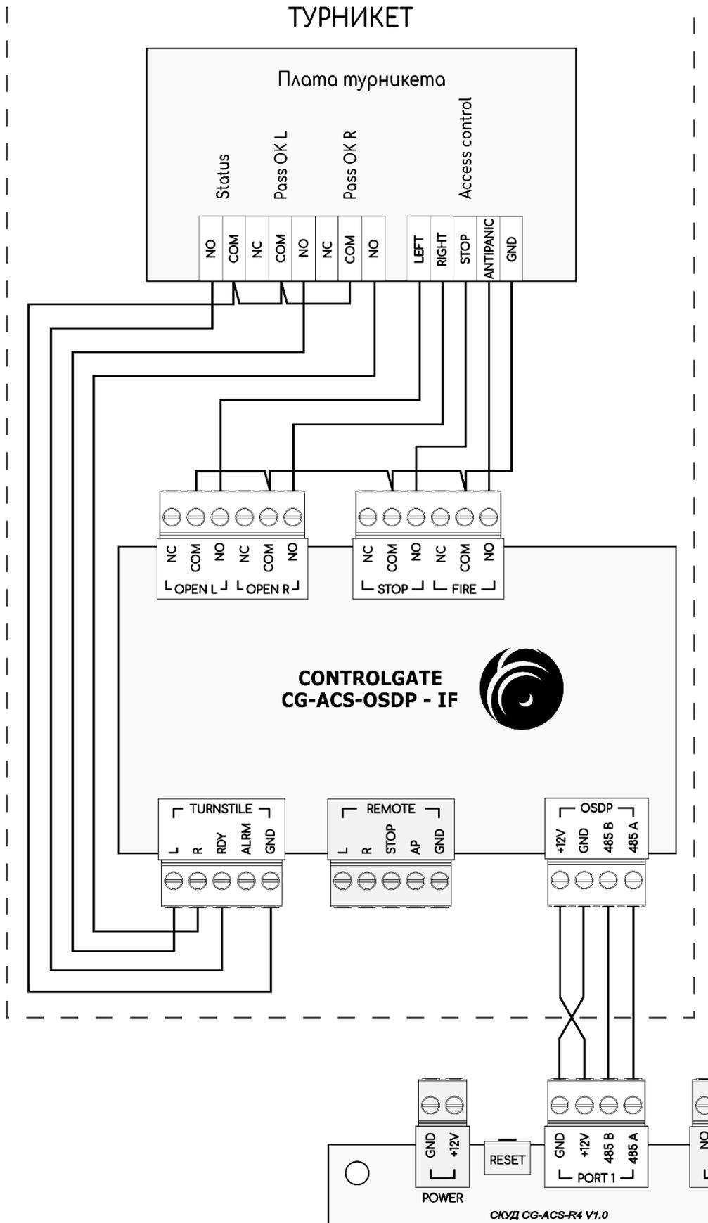
Рисунок 14. Подключение турникета через модуль сопряжения
