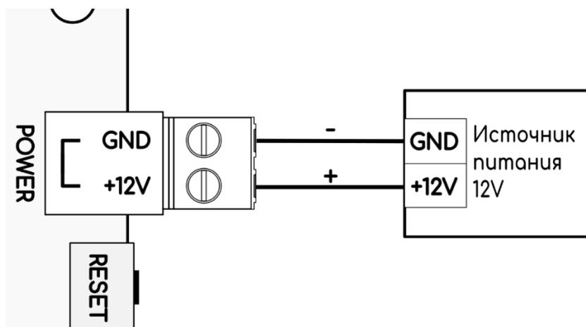
Рисунок 3. Подключение источника питания
