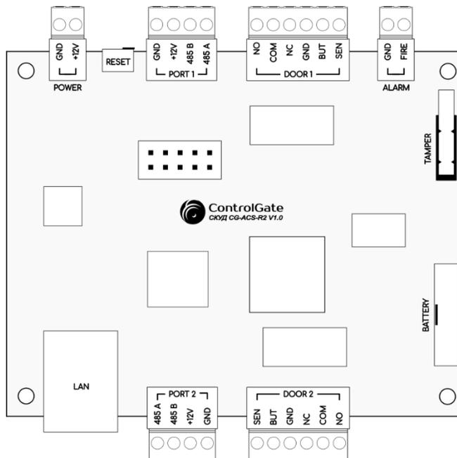
Рисунок 1. Схема расположения элементов и разъемов на плате
