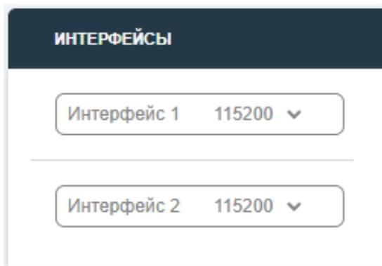
Рисунок 41. Настройка интерфейсов RS-485
