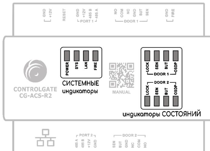
Рисунок 2. Схема расположения индикаторов
