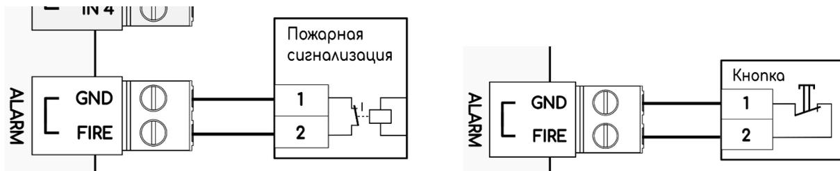
Рисунок 17. Подключение (слева) системы пожарной сигнализации, (справа) кнопки аварийной разблокировки
