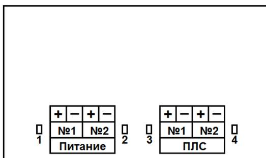
Рисунок 12 – Назначение клемм
