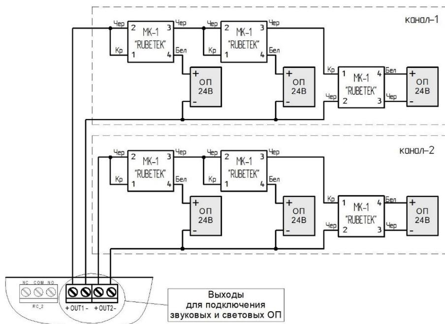
Рисунок 16 – Схема подключения звуковых и световых ОП
