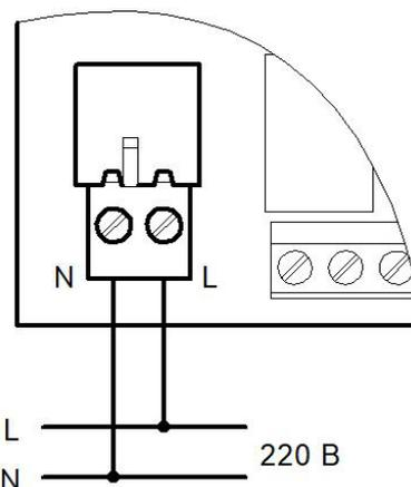
Рисунок 10 – Подключение питания клапанов
