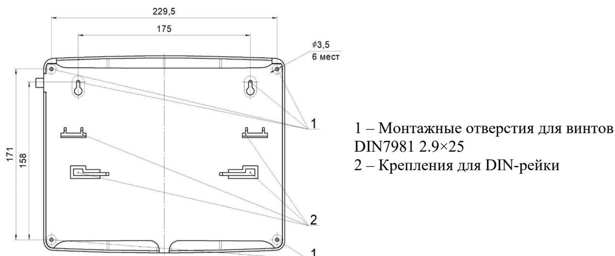
Рисунок 4 – Установочные размеры
