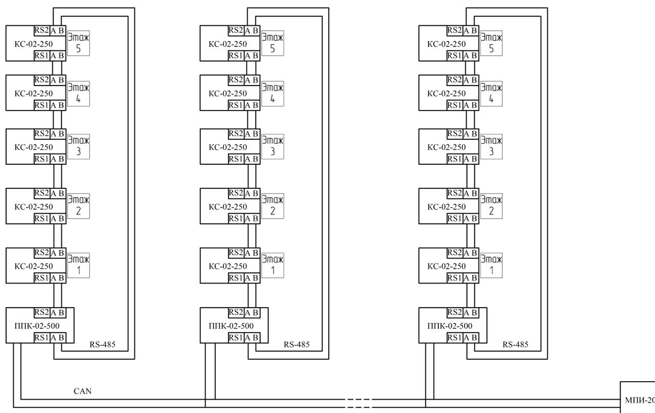
Рисунок 7 – Схема организации интерфейса RS-485
