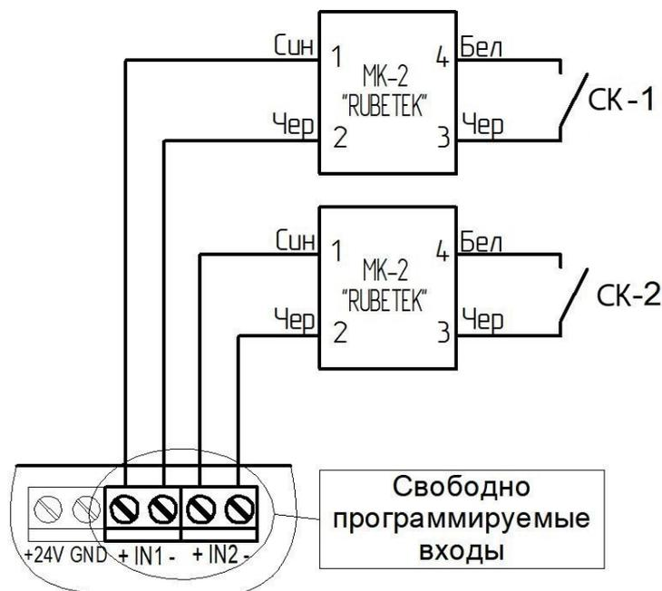
Рисунок 19 – Схема подключения свободно программируемых входов
