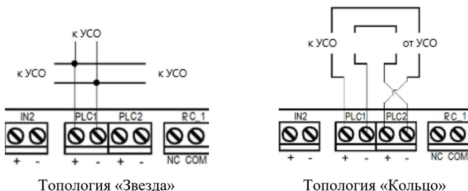
Рисунок 5 – Схемы подключения ПЛС
