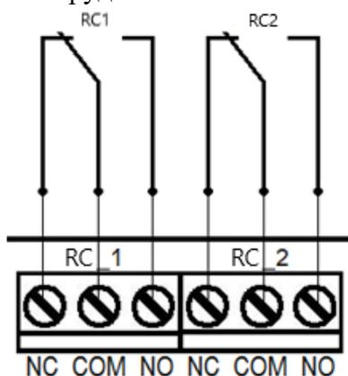
Рисунок 18 – Схема подключения к СК ППК
