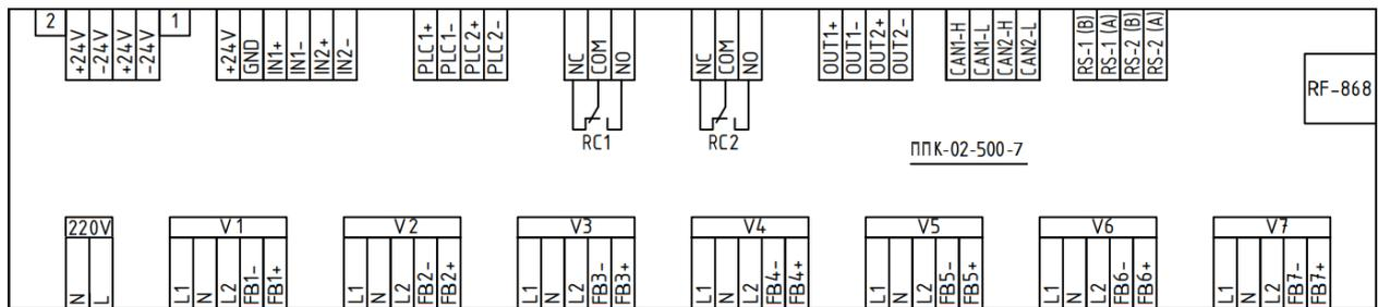
Рисунок 3 – Маркировка клемм ППК
