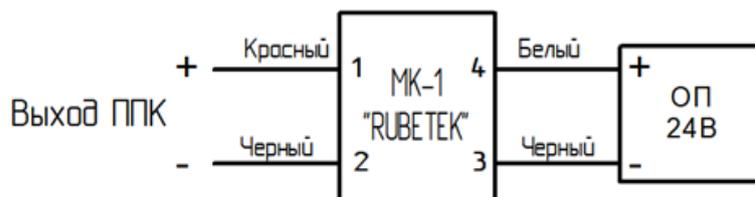
Рисунок 17 – Схема подключения МК-1 к ОП
