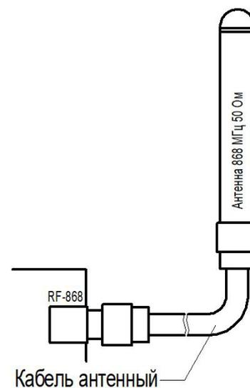
Рисунок 8 – Подключение антенны
