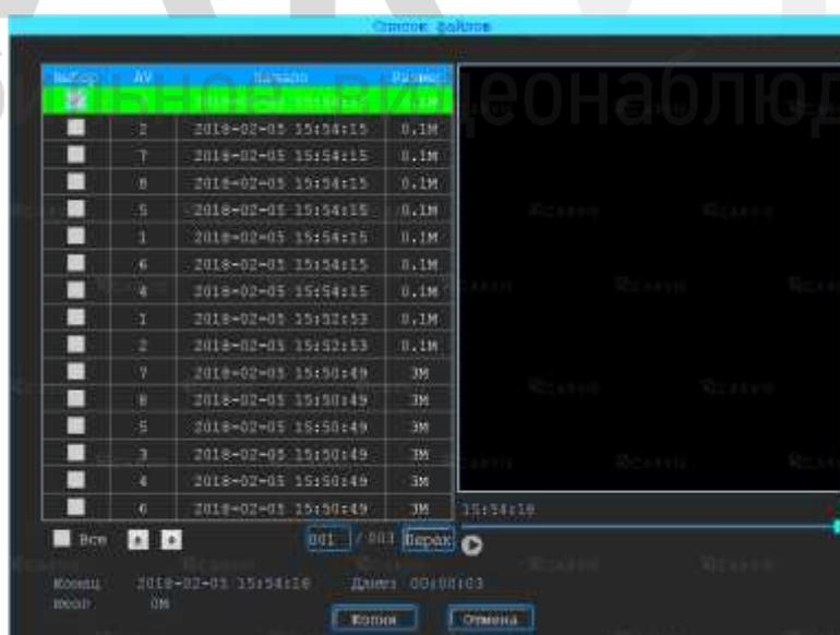
Доступны два формата для загрузки файлов на USB-носитель: \*.ifv и \*.avi (рис. 24).
