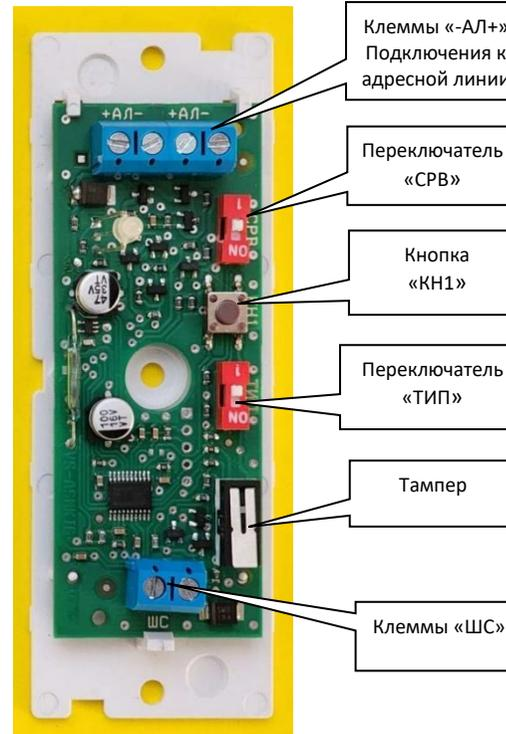
**Внимание! При проверке извещателя кнопкой «КН1» кнопка «Тампер» должна быть зафиксирована в нажатом состоянии.**
