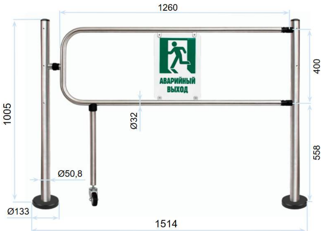
Рисунок 4.1 Габаритные размеры секции Антипаника «ХТА-04»
