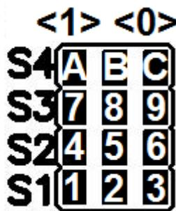
Рисунок 2.1.2 – Перемычки режимов работы платы управления
