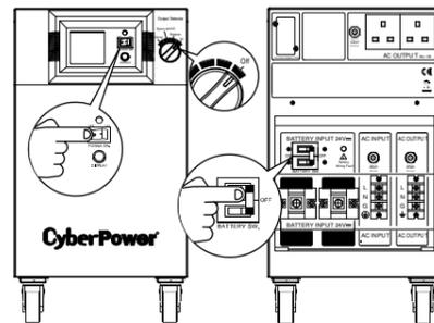
Выключатель питания, переключатель выхода и аккумуляторная батарея SW перед установкой должны быть выключены.
