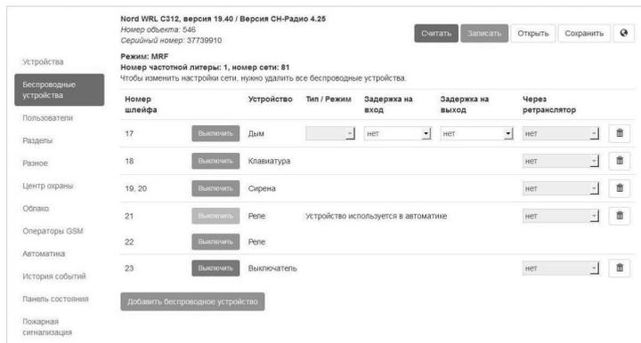
При регистрации реле в зоне радиовидимости должен быть только один охранный прибор в режиме связывания.
