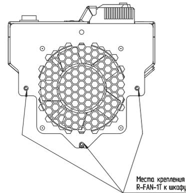
**СХЕМА КРЕПЛЕНИЯ ВЕНТИЛЯТОРА**
