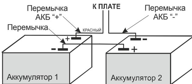
Рисунок 3 – Подключение АКБ
