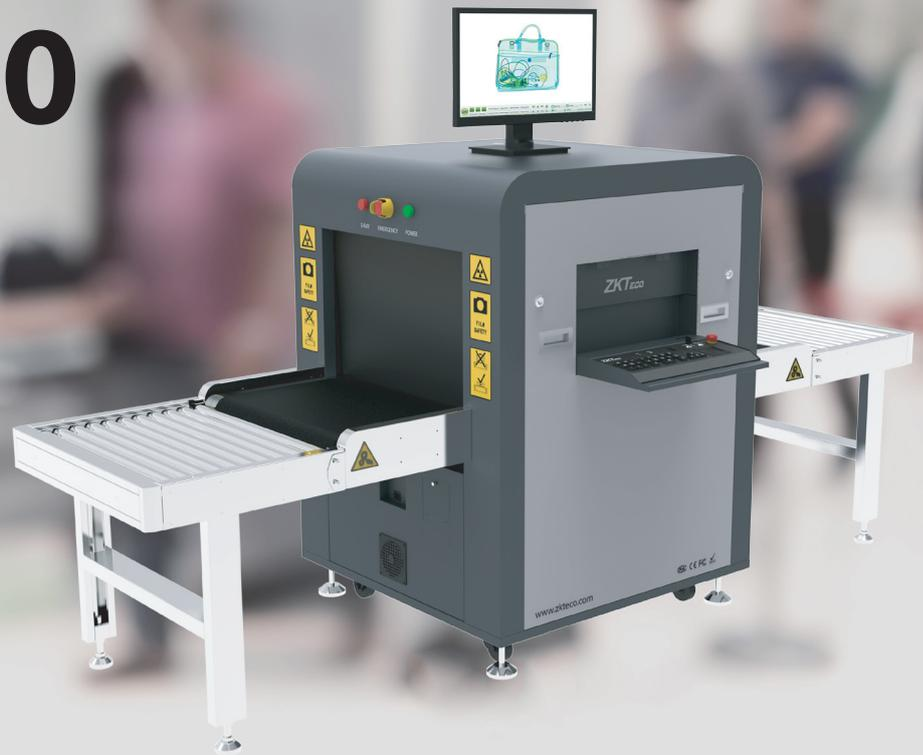
ZKX6040 es un asistente avanzado de inspección de equipaje por rayos X de doble energía cuyas capacidades incluyen la penetración de hasta 35 mm de acero con un algoritmo optimizado. La apertura del túnel es tan grande como 600 mm por 400 mm.
