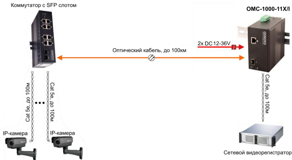
Рис.4 Типовая схема подключения медиаконвертера OMC-1000-11X/I
