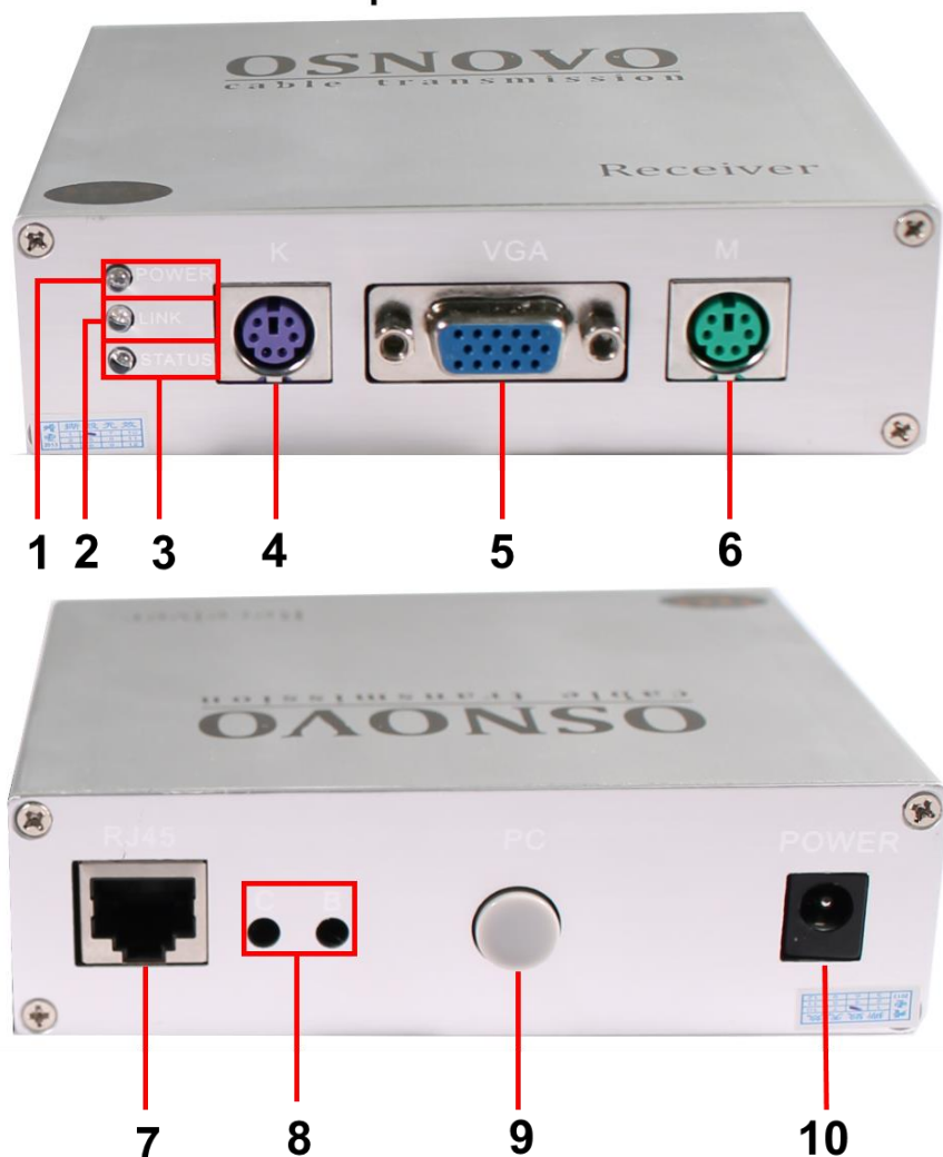
Рис. 4 RA-VKM/1, RA-VKM/6, разъемы и индикаторы передней и задней панелей приемников
